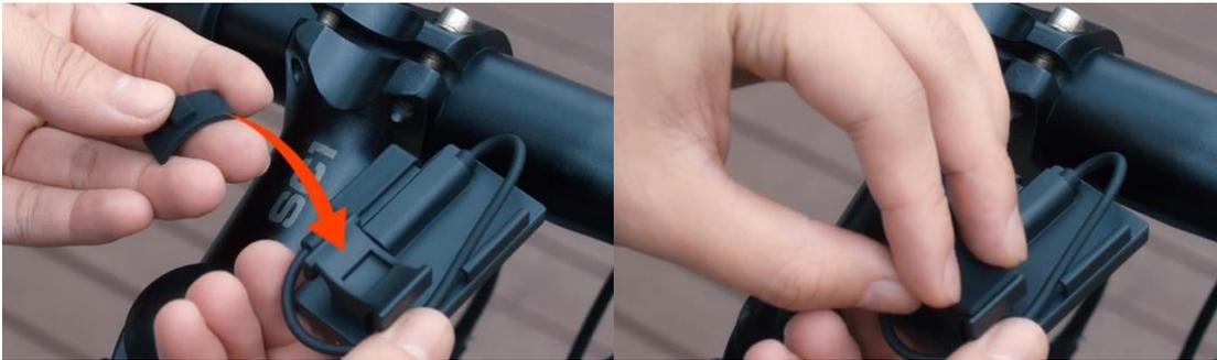
2. 적절한 크기의 고무링을 골라 태양광 충전기 양쪽의 고정 걸이에 걸어 고정합니다.
